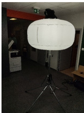
ZDJĘCIE 9 MASZT OŚWIETLENIOWY
