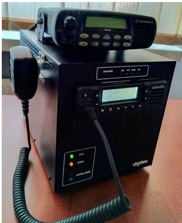
ZDJĘCIE 10 BAZOWA STACJA RADIOTELEFONICZNA
