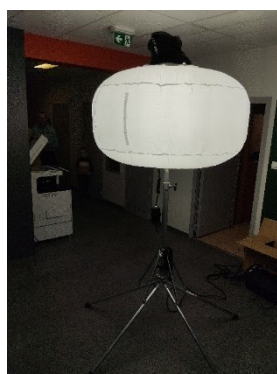
ZDJĘCIE 9 MASZT OŚWIETLENIOWY
