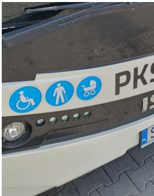
Rys. 20 Minimalne wymagania taboru – oznakowanie pojazdów
